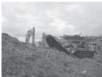
写真11 木くずの破碎
